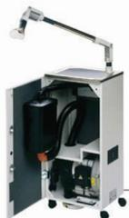
Aspiración de polvo insonorizada para un puesto de trabajo con brazo y campana. El motor esta protegido con una pastilla térmica. Tiene una potencia de 0.4KW - 3,1 A; un volumen máximo aspirado de 1250 l/min; y una presión máxima de servicio en modo continuado 1300mm H2O.
