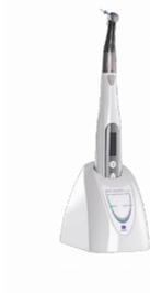
Motor compacto (80 g) de endodoncia de rotación continua inalámbrico y con funciones innovadoras. Evita tendinitis y lesiones musculares. 6 memorias de trabajo y velocidad programable de 50 a 1000 rpm. 9 valores de torque (hasta 3,9 Ncm). Funciones innovadoras de Auto torque reverse y slow-down.
