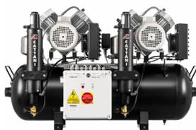
Compresor para fresadoras CAD CAM, con 2 cabezas de 2 cilindros con dos secadores de aire. Línea especial de compresores Cattani, que trabajan a presiones más altas respecto a los compresores convencionales. Dispone de 2 motores trifásicos 50 Hz y potencia total de 3 kW – 7,2 A.
